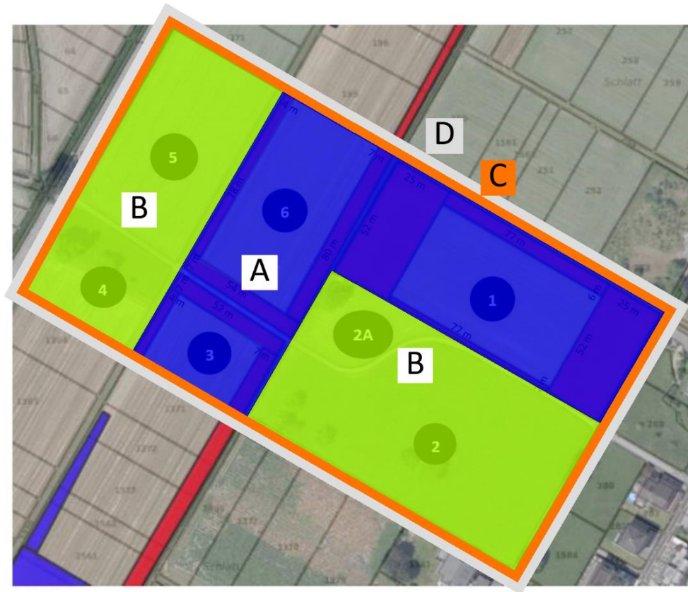
Abbildung 3: Bezeichnung der Aushubarten (Grundriss), Quelle: Eigene Darstellung SSL.
