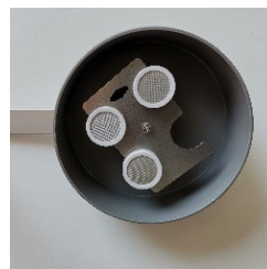
Abbildung 1 Ferm-Passivsammlergehäuse von unten. Sichtbar sind drei Sammlerplättchen in einer metallenen Halterung.
