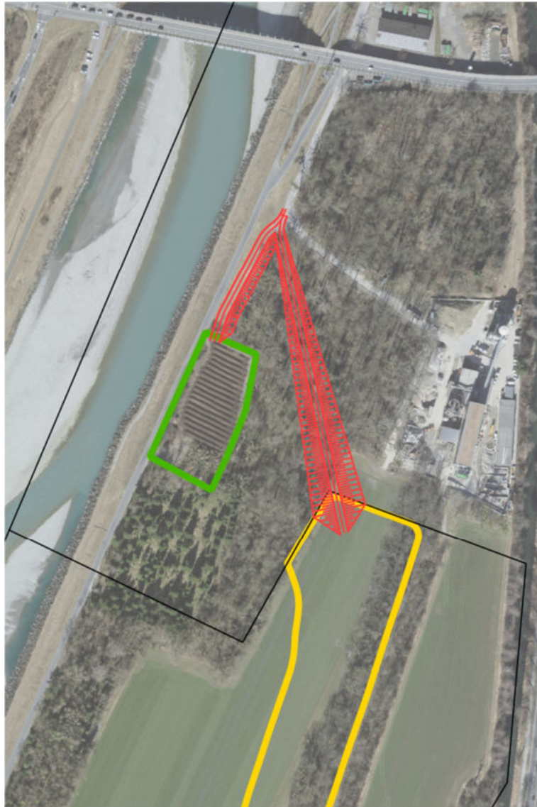
Abbildung 9: Übersicht neue Deponiezufahrt, Var. 2. Gelb = Deponieperimeter, Etappe 3 (Quelle: Schüttplan, Stand April 2022); grün = Kompostierplatz Ganada; rot = Konstruktionslinien Erschliessung. Details vgl. Übersichtsplan im Anhang.
