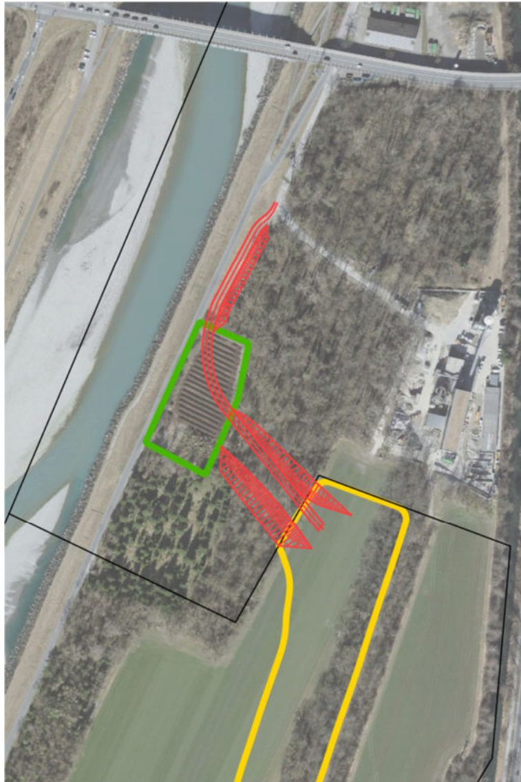
Abbildung 11: Übersicht neue Deponiezufahrt, Var. 3b. Gelb = Deponieperimeter, Etappe 3 (Quelle: Schüttplan, Stand April 2022); grün = Kompostierplatz Ganada; rot = Konstruktionslinien Erschliessung. Details vgl. Übersichtsplan im Anhang.
