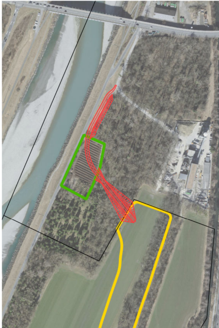
Abbildung 10: Übersicht neue Deponiezufahrt, Var. 3a. Gelb = Deponieperimeter, Etappe 3 (Quelle: Schüttplan, Stand April 2022); grün = Kompostierplatz Ganada; rot = Konstruktionslinien Erschliessung. Details vgl. Übersichtsplan im Anhang.
