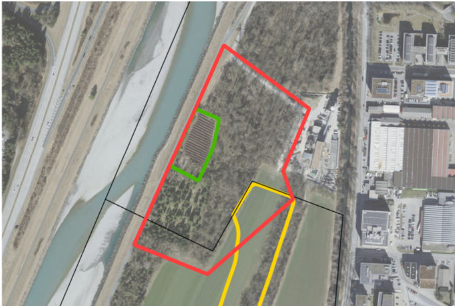
Abbildung 6: Übersicht Projektperimeter. Gelb = Deponieperimeter, Etappe 3 (Quelle: Schüttplan, Stand April 2022); grün = Kompostierplatz Ganada; rot = Planungsperimeter neue Deponiezufahrt.
