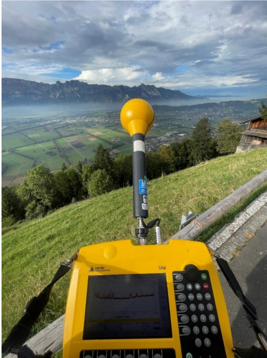
Abbildung 2: Messpunktaufnahme mit dem NARDA SRM-3006 Messgerät bei Triesenberg mit Ausblick über das Tal.
