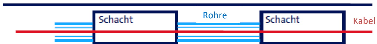
Abbildung 18 Realisierungsvariante: Verbindung Schacht – Schacht
